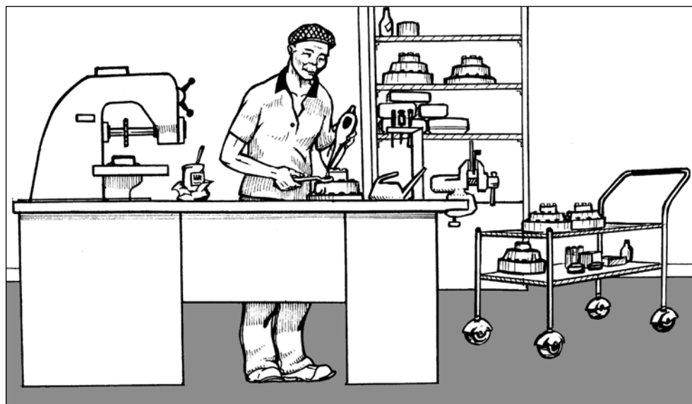
Figure 119a. Prévoir des postes de travail qui seront utilisés par des employés effectuant des tâches différentes. Cette méthode améliore les flux de travail
