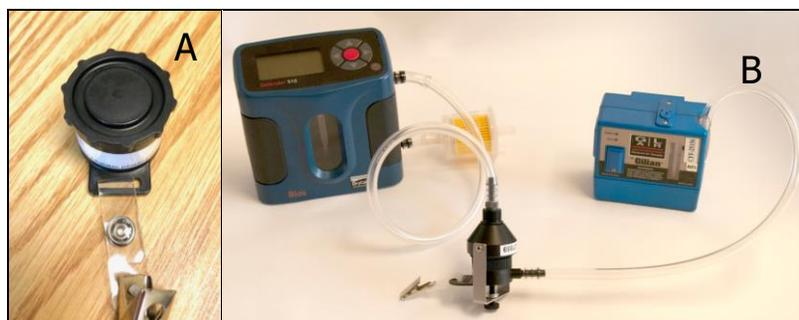
**Figure 1.** cassette DRS avec capuchons (A) et avec adaptateur pour calibration (B)
