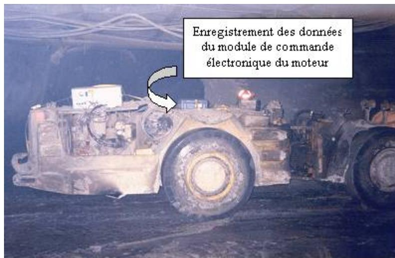
**Figure 2** Acquisition en milieu minier des données portant sur le régime et le couple moteur pour divers cycles de travail
