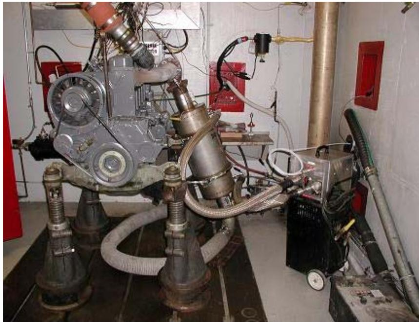
**Figure 5** Moteur Deutz F4L912W (49 hp) de la chargeuse-navette classique avec filtre à particules diesels sur le banc d'essais CANMET
