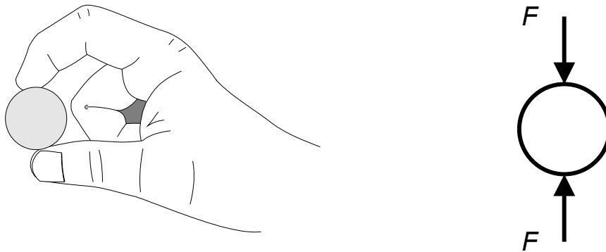
Figure 2 Cas le plus simple d'une force de serrage: deux forces co-linéaires et opposées. Exemple : serrage d'un cylindre entre deux doigts.
