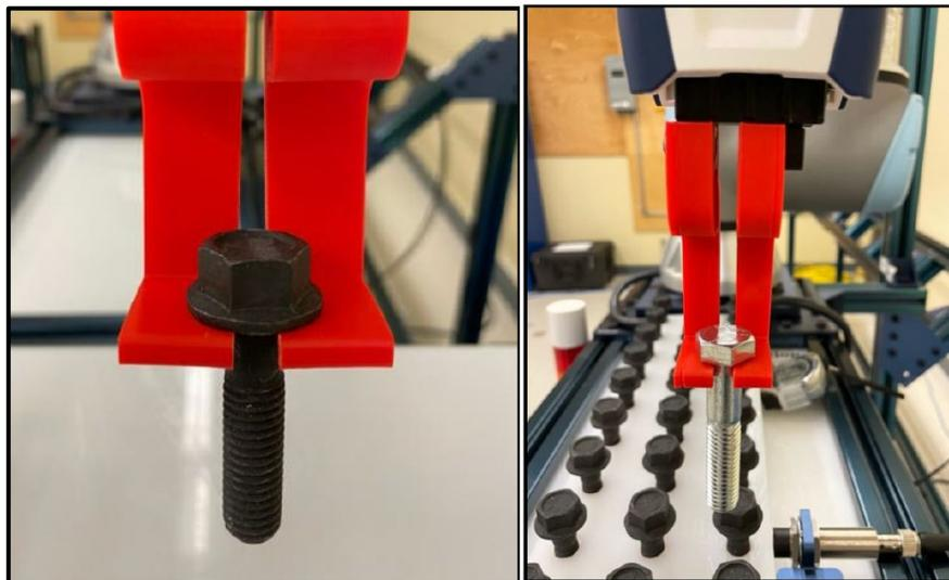
**Figure 26.** Intégrateur 2 testant la cellule cobotique : il joue le rôle de l'opérateur récupérant la vis saisie par le cobot afin de l'insérer dans le moteur simulé (source : rapport de l'intégrateur 2).
