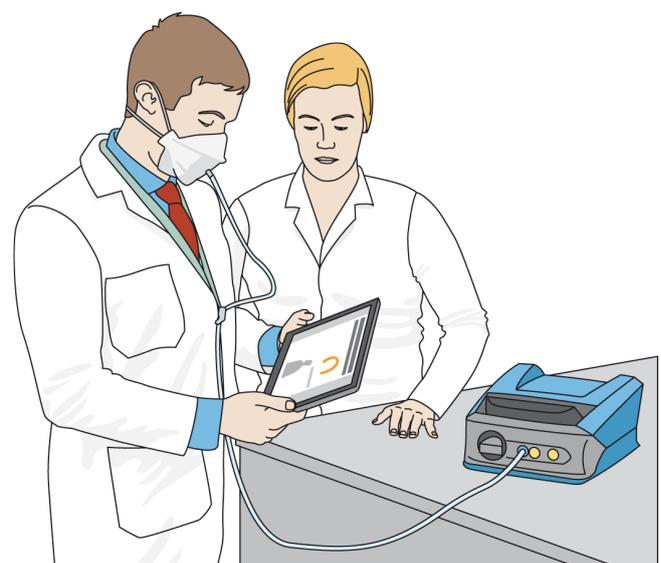
Figure 4. Essai d'ajustement quantitatif réalisé à partir d'un compteur de particules
