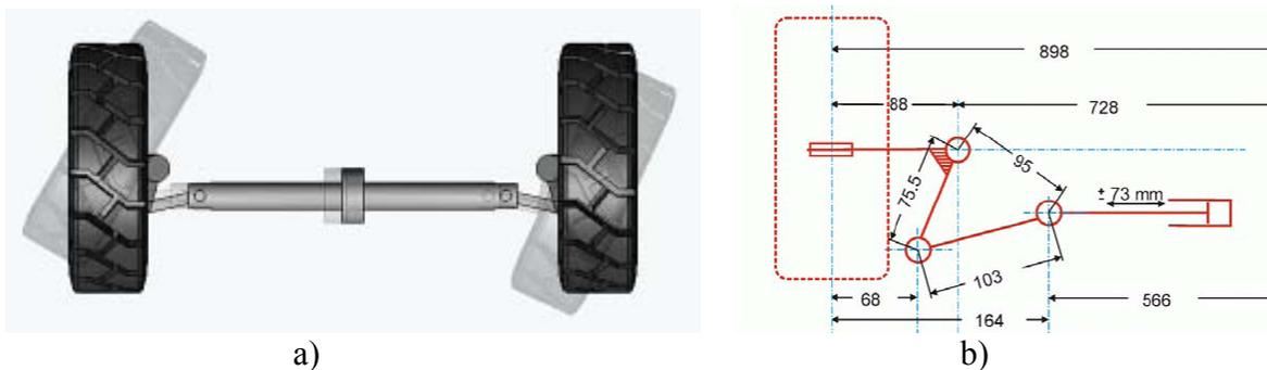
Figure 11 : Mécanisme de direction des roues arrière. a) Image vue de haut du modèle 3D. b) Plan du mécanisme à barres.
