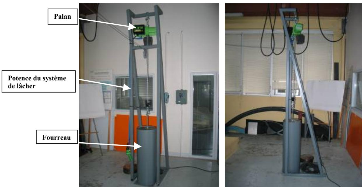
Figure 11: système de lâcher avec le palan utilisé pour relever les masses.
