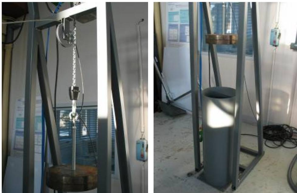
Figure 2 : système de lâcher pour mise en mouvement du banc.
