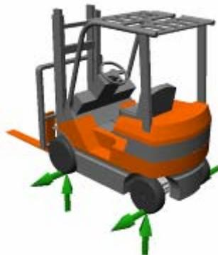
Figure 12 : Point d'application des forces d'interaction pneu/sol
