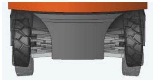
Figure 10 : Mobilité de l'essieu oscillant de l'axe arrière.
