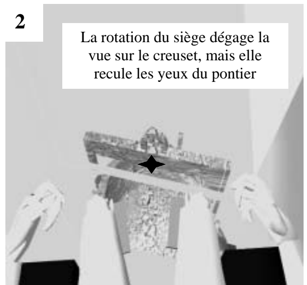
Siège reculé et tourné de 75°. Le pontier étant derrière le pivot, la rotation l'éloigne de la fenêtre.
