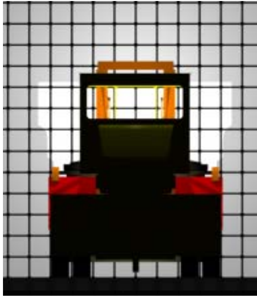
Figure 3 – Carte de visibilité de la cabine élargie. Projection au mur (homme 50 percentile)
