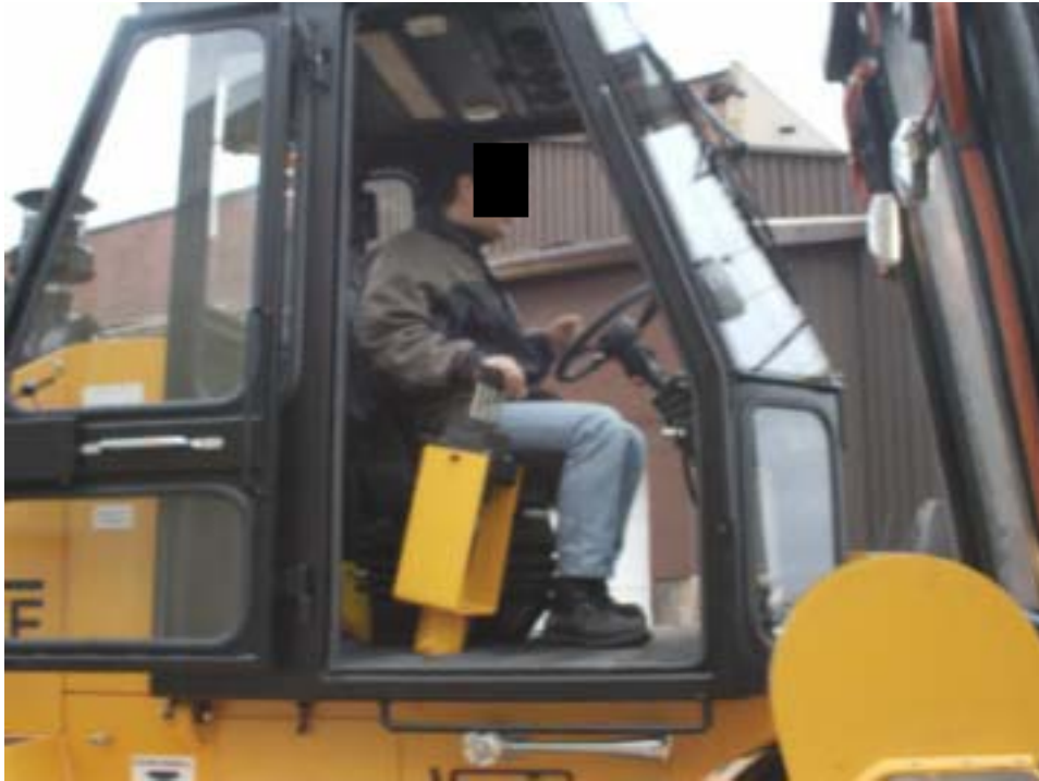
Figure 10 – Essai en cours de fabrication. Nouveau siège, nouvelles manettes, nouveau volant
