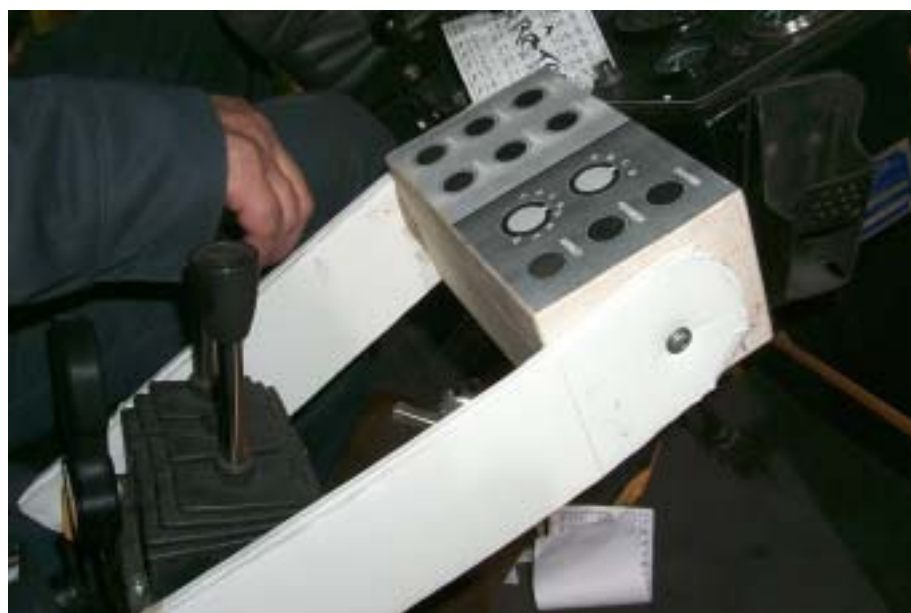
Boîtier de contrôle d'ouverture des portes de garage
