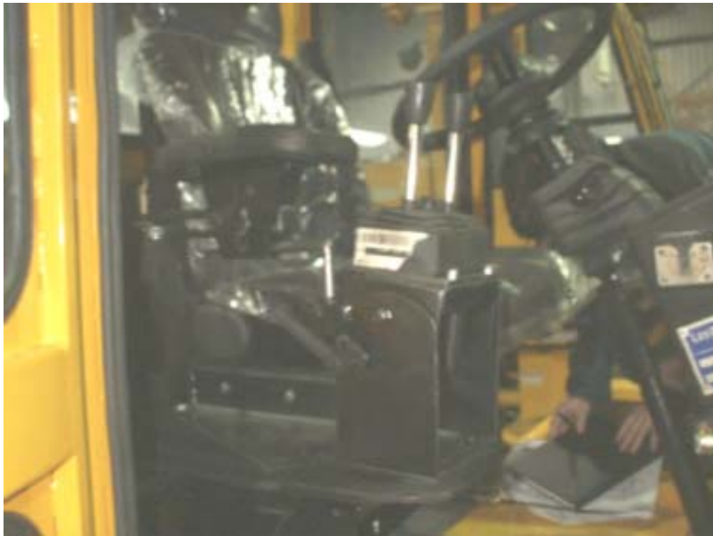
Figure 10 – Essai en cours de fabrication. Nouveau siège, nouvelles manettes, nouveau volant
