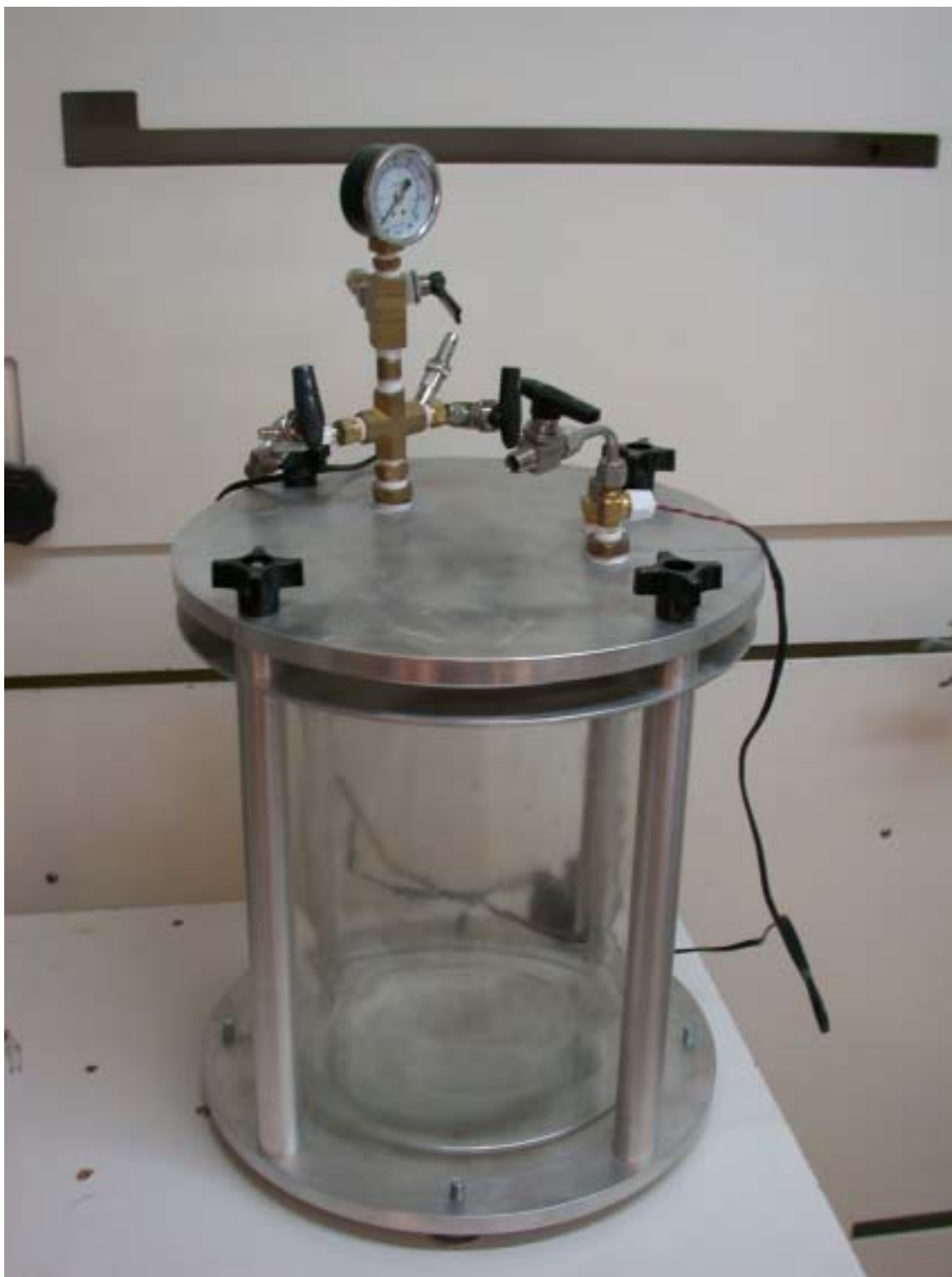
FIGURE 1 : SCHÉMA DE LA CHAMBRE DE GÉNÉRATION
